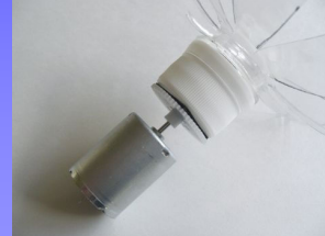
発電機に取付ける
